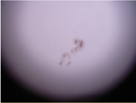
Starke Abschottung durch zu kleine Öffnung im Sonnenfilter.
